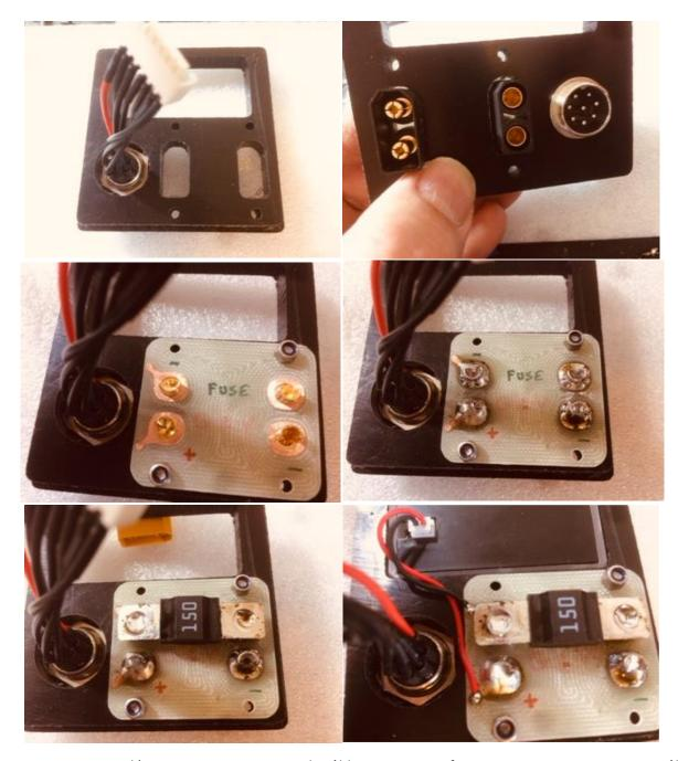
Note: une prise XT90 supplémentaire et 2 morceaux de câble 10AWG sont fournis pour vous permettre un câblage vous évitant de souder directement la batterie sur le PCB; dans ce cas vous souderez les câbles rouges et noirs sur les bornes repérées + et – sur les photos.
