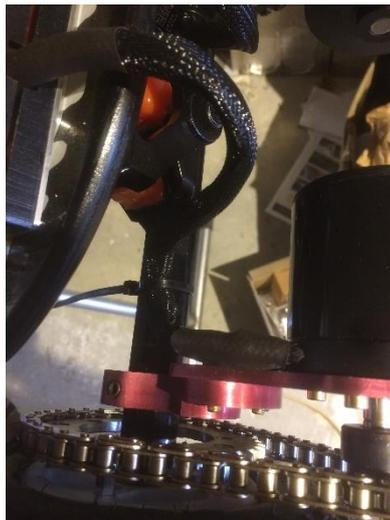
On utilise idéalement 4 vis pour solidariser les motor mounts aux truck mounts, néanmoins 2 à 3 vis suffisent et peuvent être placées à votre convenance pour obtenir la tension de chaîne idéale et le positionnement des moteurs à l'angle de votre choix ou presque.
